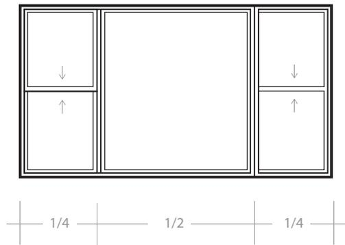
Fenêtre avec partie ouvrante à guillotine et partie fixe
