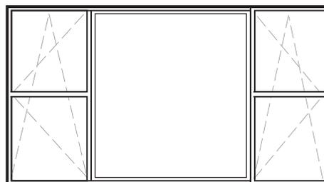
Fenêtre avec partie ouvrante battante ou oscillo-battante et partie fixe
