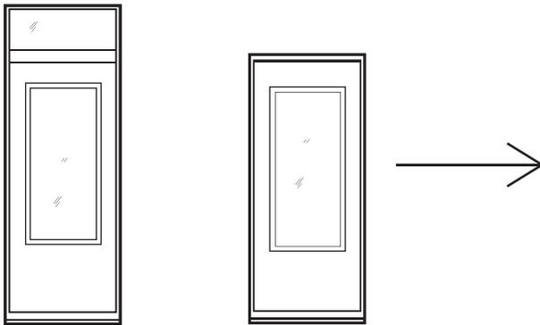
La surface vitrée d'une nouvelle porte devra avoir une hauteur minimale de 48 po et une hauteur maximale de 64 po.
