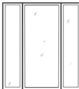
\* La surface vitrée d'une nouvelle porte devra avoir une hauteur minimale de 48 po et une hauteur maximale de 64 po.
