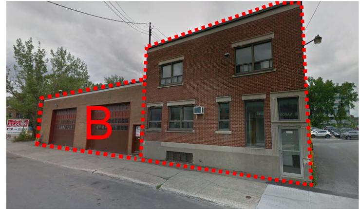
La construction est constituée d'une structure d'acier avec un revêtement extérieur en briques brunes sur sa façade avant un revêtement en crépi sur ses trois autres façades.
