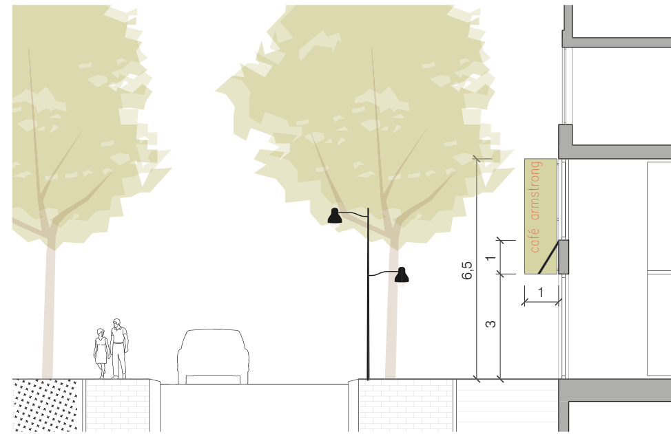
L'affichage vertical en saillie est positionné dans la partie supérieure du socle commercial et ponctue le parcours le long de la rue.
