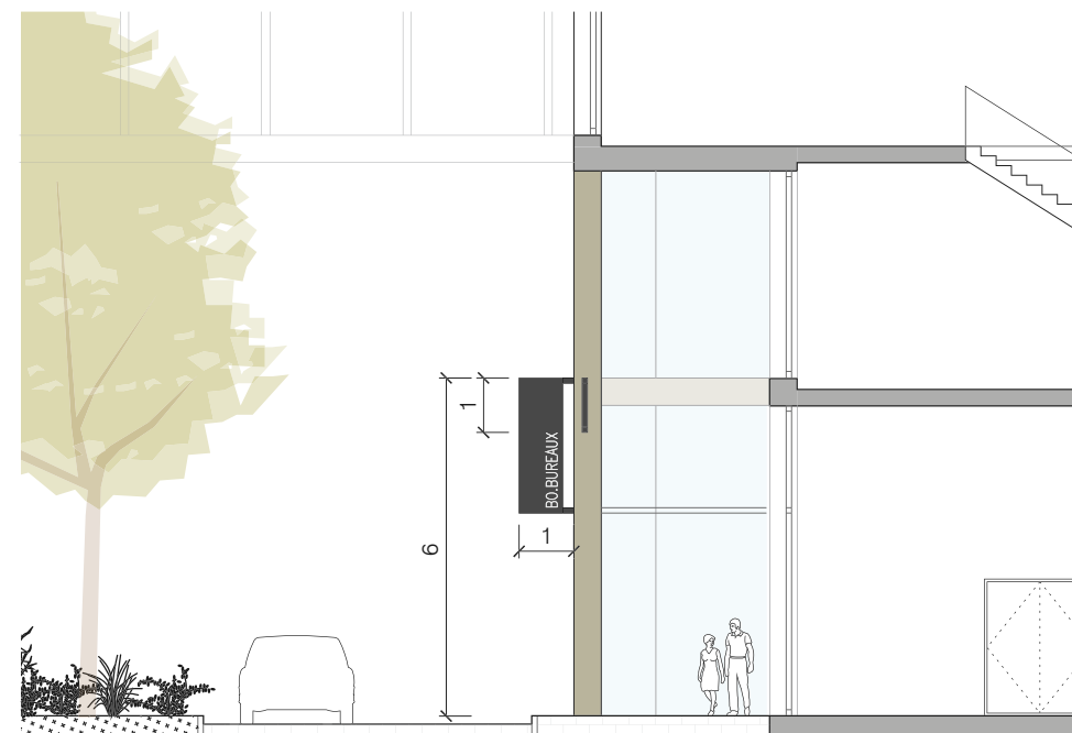
L'affichage vertical en saillie est positionné dans la partie supérieure du socle commercial et ponctue le parcours le long de la rue.
