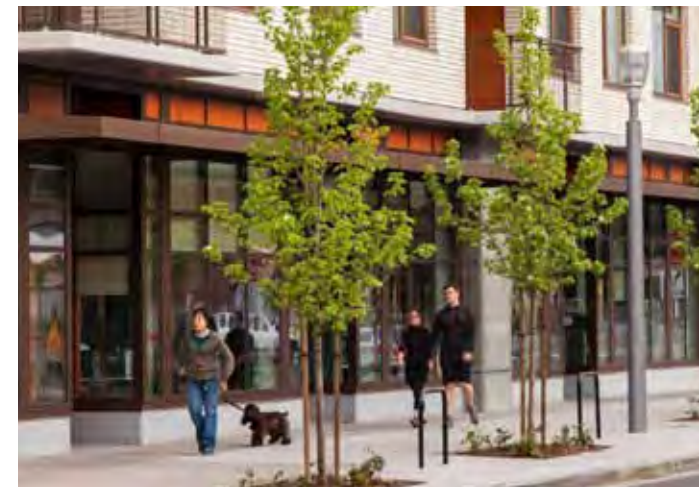
Les entrées des commerces sont identifiées par un retrait et la présence d'une marquise.
